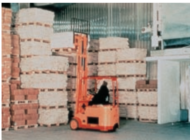
Abb. 14: Gabelstapler und Lagergut belasten den wärmege- dämmten Kühlhausboden.
