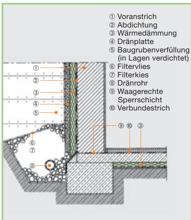
Abb. 24: Aufbau einer Perimeterdämmung, kombiniert mit einer Dränung.
